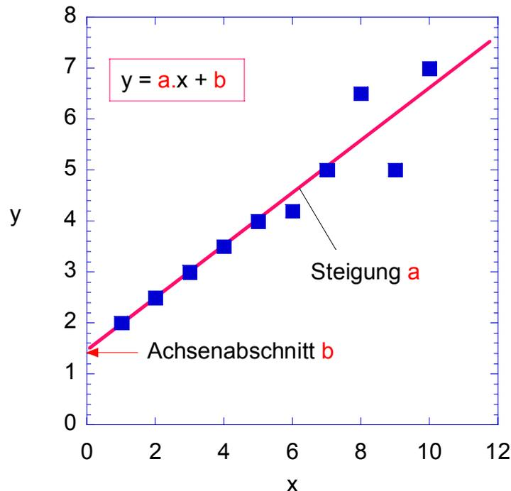
Welches ist die Gerade  $y = a \cdot x + b$ , die die Meßwerte am besten beschreibt? Gesucht sind also die Werte  $a$  und  $b$ , für die die Summe  $S$  der Quadrate der vertikalen Abstände zwischen den Meßpunkten und der Geraden so klein wie möglich ist, d.h.
