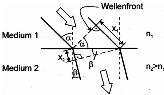
Trifft ein Strahl nicht senkrecht auf eine Grenzfläche, wird er gebrochen, d. h.  $\alpha \neq \beta$ . Die Senkrechte zur Oberfläche, das Lot, ist kurz-gestrichelt eingezeichnet, die Wellenfront lang-gestrichelt.
