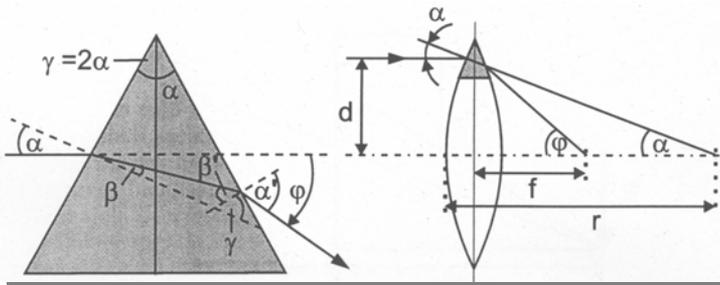
Elementarprisma, aus dem man sich eine sphärische Linse zusammengesetzt vorstellen kann und aus dem man die Brennweite einer solchen Linse berechnen kann. Die Linse habe den Brechungsindex  $n$ , der von Luft sei gleich Eins.
