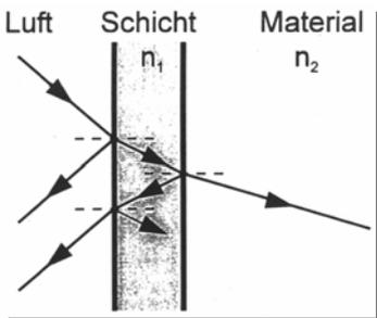
Interferenzen zwischen zwei reflektierten Strahlen können destruktiv sein (Anti-reflexionsbeschichtung) oder konstruktiv (Verspiegelung) je nachdem, wie man die Schichtdicke und die Brechungsindizes wählt.
