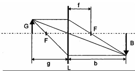
Die Listing'sche Strahlenkonstruktion für eine dünne Linse  $L$ . Die Brennweite ist  $f$ , die Gegenstandsweite  $g$ , die Bildweite  $b$ . Der Brennpunkt wird mit  $F$  bezeichnet.
