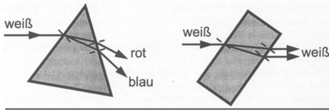
Am Prisma und an planparallelen Platten finden je zweimal eine Brechung eines Lichtstrahls statt; beim Prisma addiert sich der Ablenkwinkel, so dass eine Farbzerlegung stattfindet.
