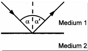
Für eine einfache Grenzfläche zwischen zwei Medien gilt, dass der Einfallswinkel zum Lot gemessen gleich dem Reflexionswinkel ist.
