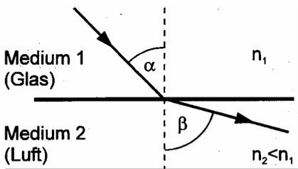
Beim Übergang vom optisch dichteren (z. B. Glas) zum optisch dünneren Material (Luft) wird ein Strahl vom Lot weggebrochen.
