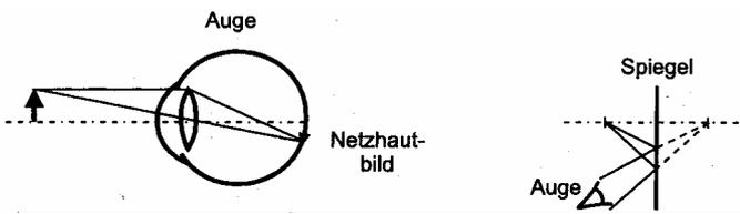
Ein reelles Bild entsteht im Schnittpunkt von Lichtstrahlen, z. B. auf der Netzhaut des Auges oder auf dem Film einer Kamera (links). Ein virtuelles Bild entsteht, wenn Strahlen nicht durch einen gemeinsamen Punkt gehen, bevor sie ins Auge gelangen. Man kann das Bild nur sehen, wenn man in Strahlrichtung blickt (rechts).
