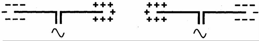
Bei angelegter Wechselspannung an einem Hertz'schen Dipol befindet sich die negative Ladung einmal vorwiegend links und einmal rechts am Ende. Die Frequenz, mit der die Ladungen hin- und her schwingen, entspricht der Frequenz der angelegten Wechselspannung.
