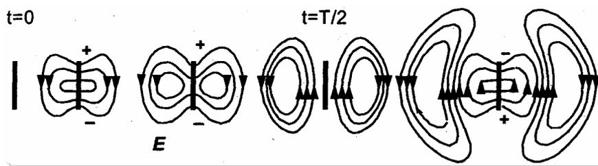
Zeichnet man die Feldlinien ein, die beim oszillierenden Hertz'schen Dipol entstehen, kann man die sich ablösende elektromagnetische Welle sehen. Gezeichnet sind lediglich die elektrischen Feldlinien; die magnetischen sind kreisförmig um den Dipol angeordnet und kehren ihre Richtung ebenfalls alle halbe Periode  $T/2$  um.
