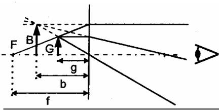
Befindet sich ein Gegenstand  $G$  dichter als  $f$  an einer Linse, erzeugt die Listingkonstruktion rechts divergierende Lichtstrahlen, also ein virtuelles Bild. Sieht man von rechts auf die Linse, ergibt der Schnittpunkt der rückwärtig verlängerten gestrichelten Linien das vergrößerte Bild  $B$ .
