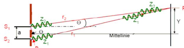
Die beiden kohärenten Wellenzüge  $Z_1$  und  $Z_2$  verlassen zur gleichen Zeit die Spalte  $S_1$  und  $S_2$ ; sie legen jedoch unterschiedliche Wege  $r_1$  und  $r_2$  zurück, mit  $r_1 - r_2 = S_1B$ . Daher gelangen sie zu verschiedenen Zeiten in P an, d.h. sie verschieben sich gegeneinander.
