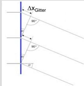
Im Vergleich zu einem Strahl, der aus dem ersten Spalt gebeugt wird, hat ein Strahl aus dem zweiten Spalt eine Phasenverschiebung  $\varphi_{\text{Gitter}}$ , die durch den Spaltabstand s gegeben ist. Der Wegunterschied der Wellenfront mit Wellenvektor  $k=2\pi/\lambda$  beträgt
