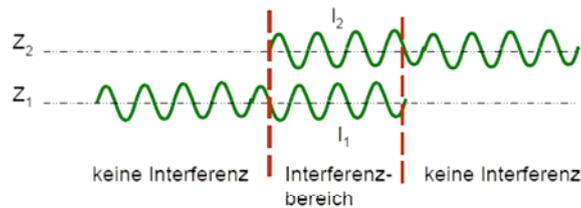
Offensichtlich: Je größer der Wegunterschied  $r_1 - r_2 = S_1B$  ist, desto kürzer der Interferenzbereich beider Wellenzüge.
