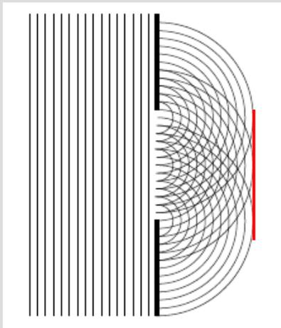
Methode zur Konstruktion der Welle hinter dem Spalt:
